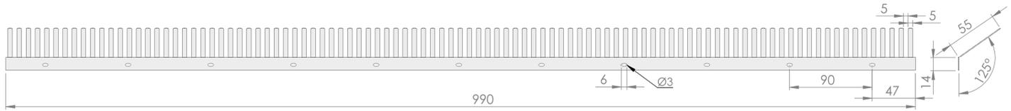
Closoir de longueur 990mm avec un talon de 14mm, et des dents de longueur 55mm, 5mm de large et espacées de 5mm.
